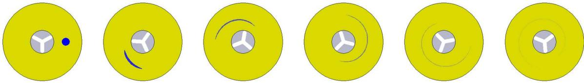
Abbildung 7-7 Ein Zylinder ist mit Glycerin gefüllt, der innerer Zylinder ist drehbar. Ein Tintentropfen wird eingebracht und der innerer Zylinder rechts herum gedreht. Der Tropfen löst sich langsam auf
